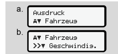
Abb. 91: Menüfolge Ausdruck - Geschwindigkeitsüberschreitung
