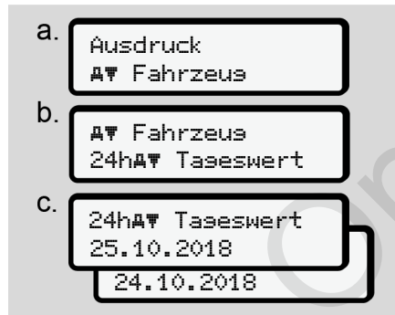
Abb. 89: Menüfolge Ausdruck - Tageswert für Fahrer-1 und Fahrer-2
