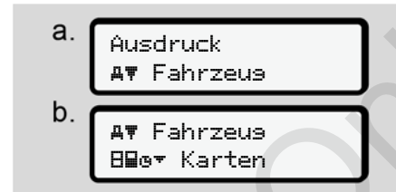
Abb. 93: Menüfolge Ausdruck – Info Tachographenkarten
