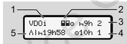
Abb. 75: VDO Counter – Statusanzeige
