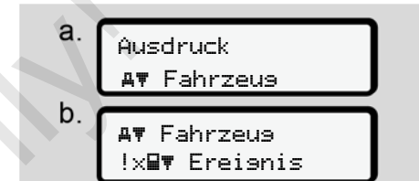
Abb. 90: Menüfolge Ausdruck - Ereignisse Fahrzeug
