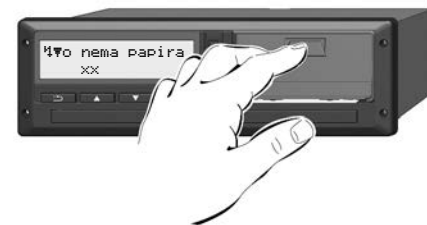
Slika 127: Pritiskanje tipke za deblokiranje
