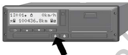
Slika 52: Vađenje kartice prijevoznika (kombinirana tipka)
