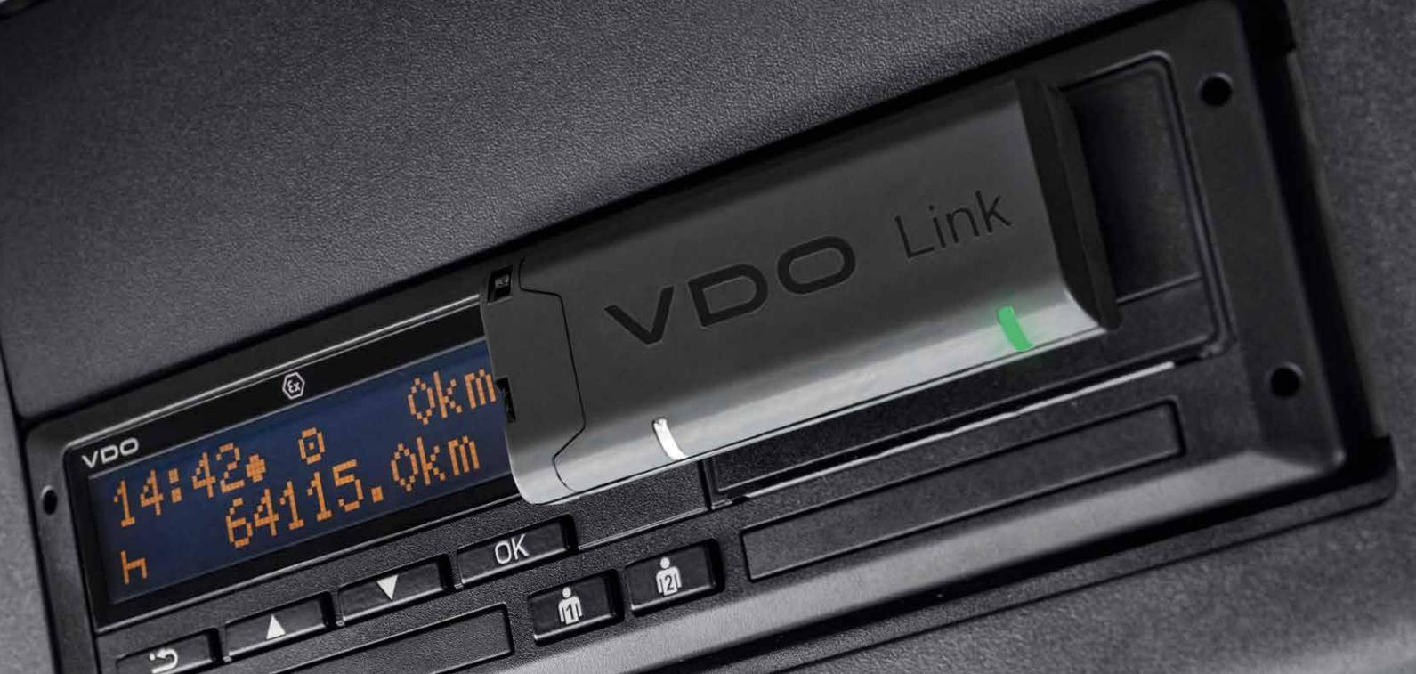
**VDO Link** – die smarte Lösung, um Fahrzeug- und Fahrerdaten aus dem Tachographen in Echtzeit zu nutzen. Mit dieser Plug & Play Telematik reduzieren Sie Zeitaufwand und Kosten und erhöhen somit Ihre Effizienz. Die Daten werden automatisch aus dem Tachographen in die VDO Cloud übertragen und in Verbindung mit unseren VDO Fleet Services erfüllen Sie so stressfrei rechtliche Anforderungen und erhalten wertvolle Informationen, um Ihre Flotte erfolgreich zu steuern.
