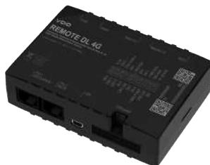
Χρησιμοποιώντας το Remote DL 4G της VDO, μπορείτε να μεταφέρετε δεδομένα λήψης μέσω GPRS στο σύστημα διαχείρισης του στόλου σας ή σε ένα λογισμικό αξιολόγησης.
