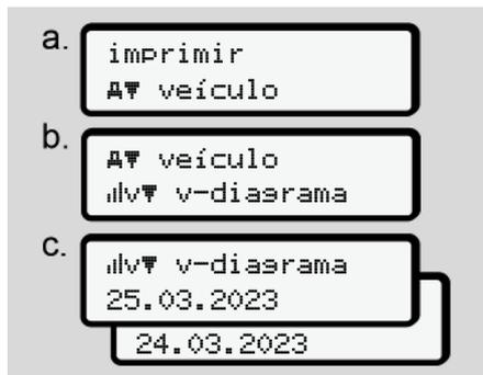
Fig. 92: Sequência de menu de impressão – diagrama v
