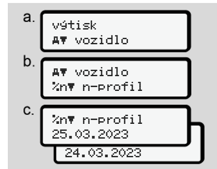
Obr. 96: Posloupnost výtisku – profily frekvence otáček
