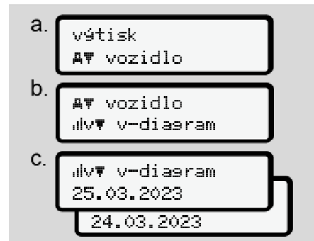
Obr. 93: Posloupnost výtisku – v-diagram
