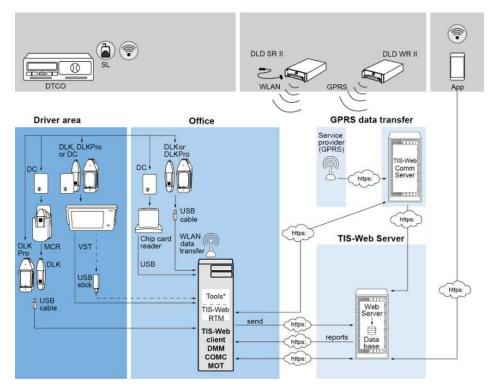
TIS-Web Data Manage-**App** Application Software: **DMM**  TIS-Web Fleet App DC Driver Card/ Fahrerkarte COMC **TIS-Web Communicator** DLD SR II **Download Device Short MOT TIS-Web Motion** Range II **DLD WR II** Download Device Wide **MCR** Mobile Card Reader Range II DTCO® SmartLink **DLK** Download Key zur Über-SL tragung von Fahrerkartenund Massenspeicherdaten **DLK Pro** Neue Generation des **Tools** • TIS-Web Automatic Download Key Upload TIS-Web Connect TIS-Web Extract
